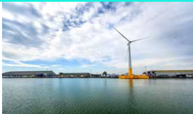
Éolienne flottante Floatgen en cours de montage dans le bassin de Saint-Nazaire DR Ideol BYTP ECN Myphotoagency
