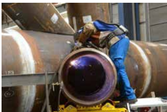
Jacket de sous-station en cours de soudure aux Chantiers de l'Atlantique
